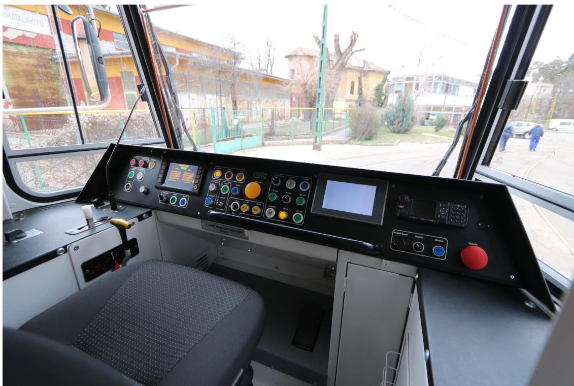
3.1. kép: Tatra T5C5K2 típusú villamos vezetőfülkéje
