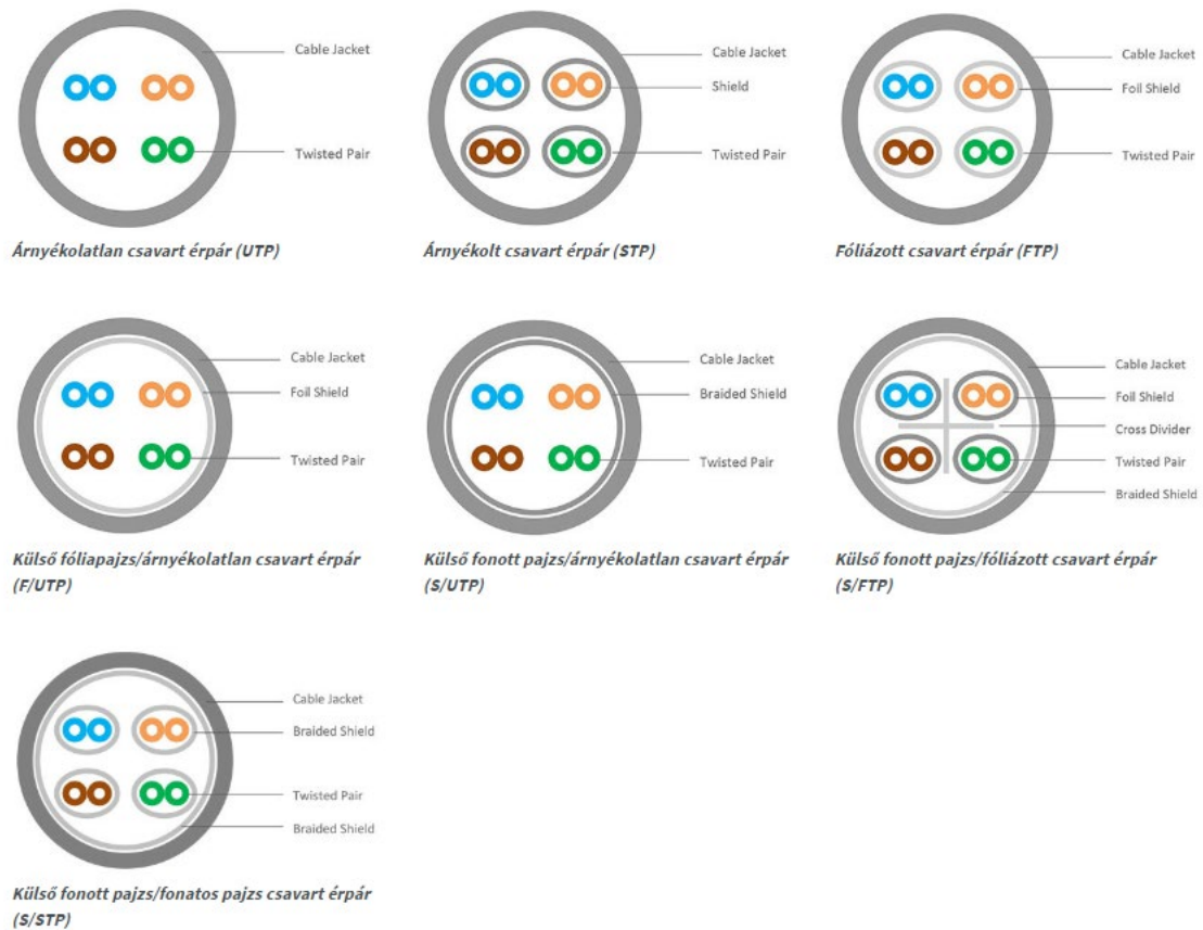
10. ábra Kábel árnyékolási típusok
