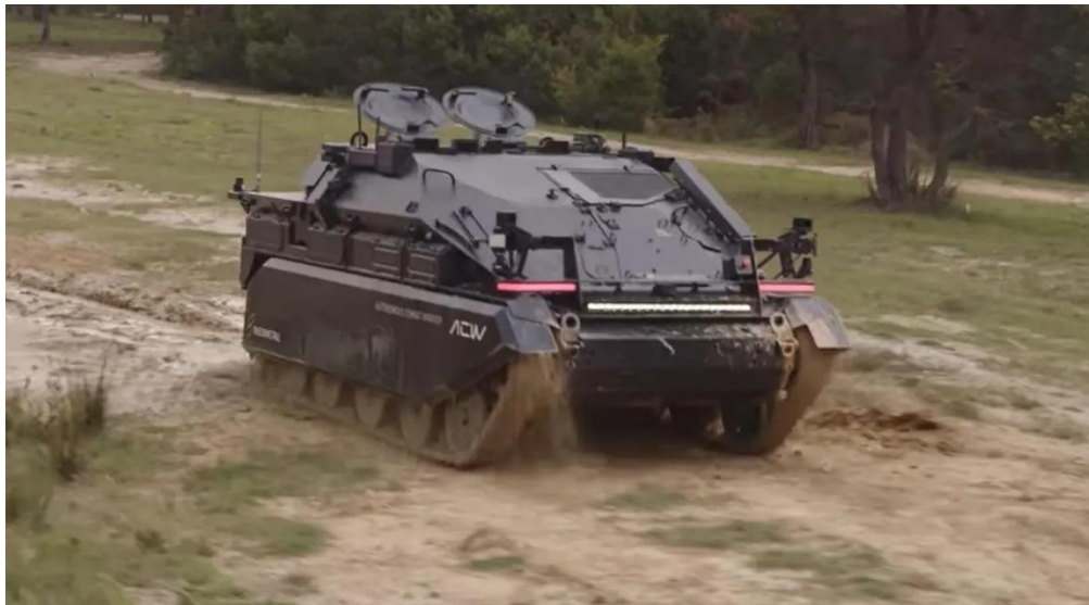
19. ábra Önvezető tank bevetésben.
