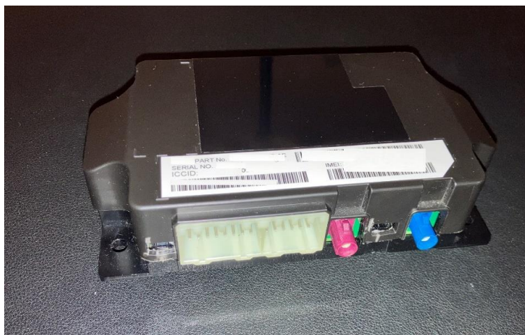
4. ábra Telekommunikációs vezérlőegység
