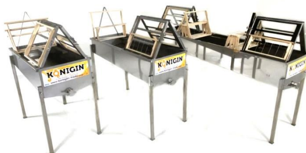
8. ábra: FK-95-2 Fedelezőkád: 1 kerettartó, 2 munkaállvány
