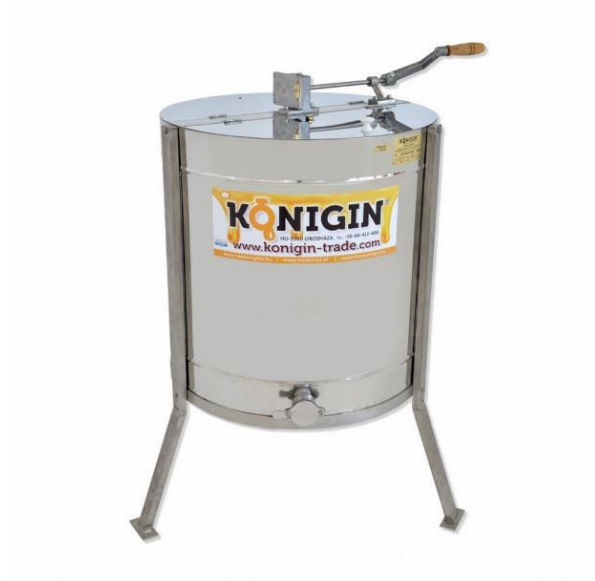
5. ábra: 50-3-TK 3 keretes tangenciális kézi mézpergető, minden keretmérethez
