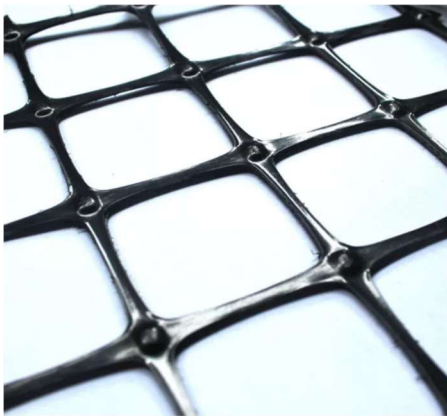
30. ábra Merev csomópontú georács Szakítószilárdsága min. 30 kN/m 2 (Z 0/63 vagy Z 0/90 zúzottkő használható)
