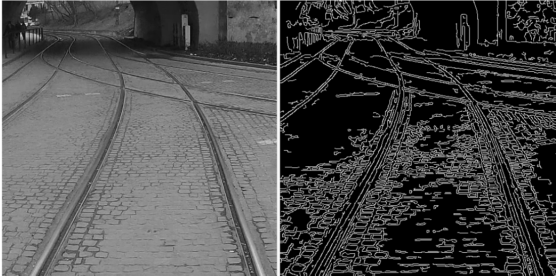
5. ábra. Bazaltkőkockás pályán alkalmazott Canny operátor előtte és utána
