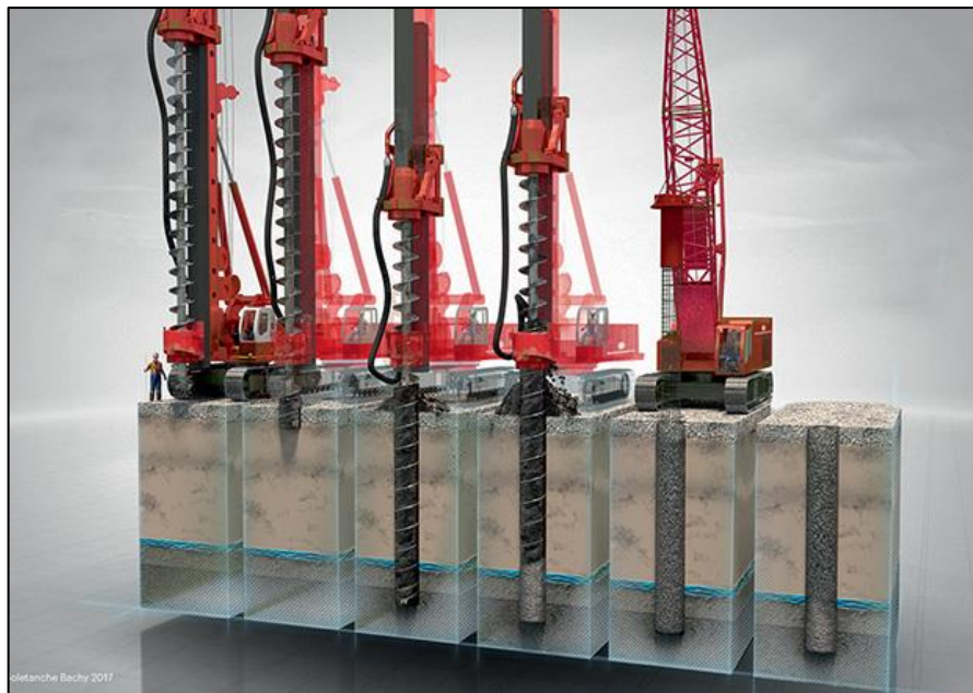
12. kép CFA cölöpözés megvalósítása. Forrás: [18]
