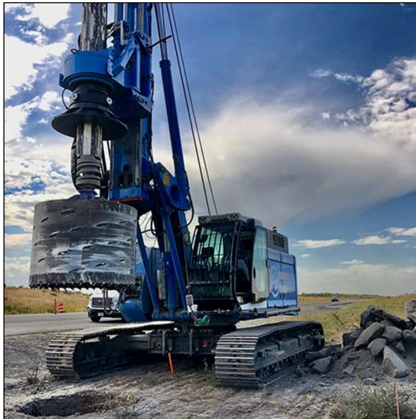
13. kép Dobfúróval felszerelt cölöpöző gép. Forrás: [19]
