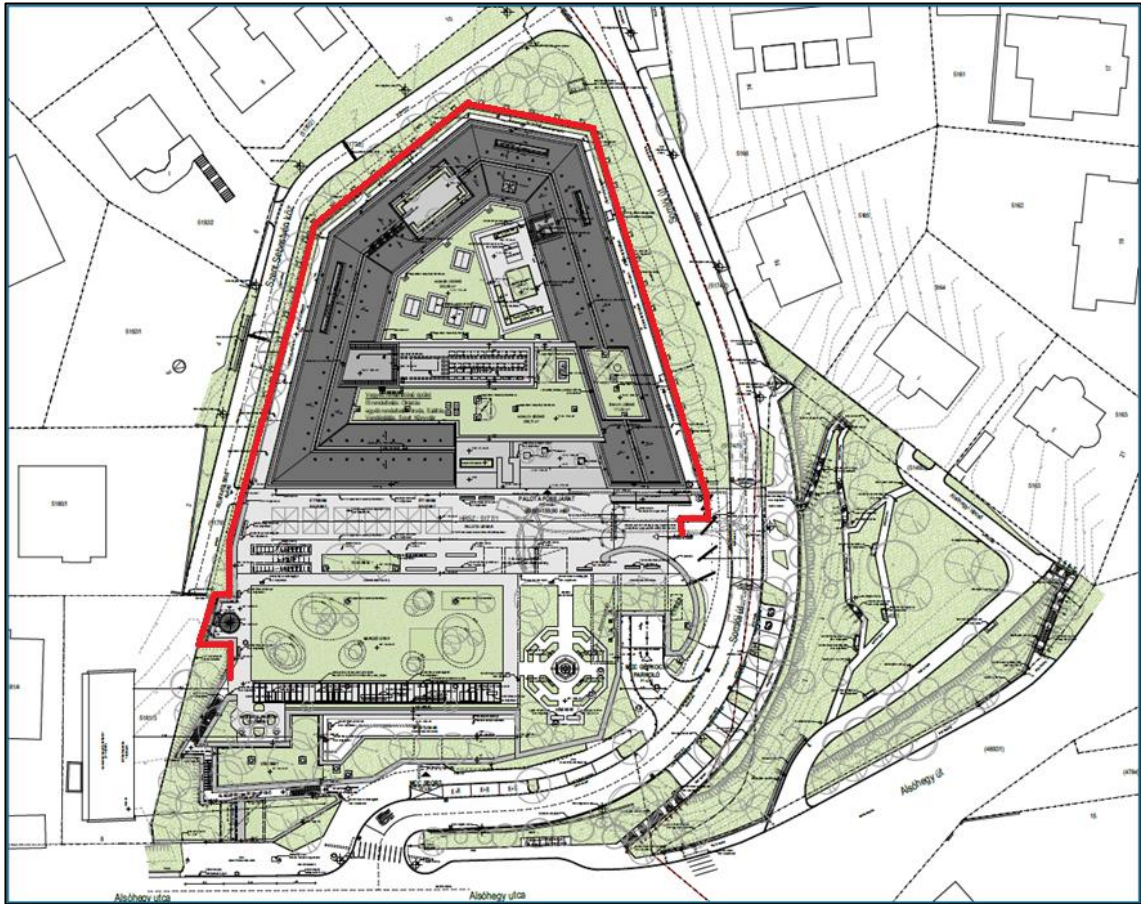
25. kép A tervezett épület helyszínrajza, piros vonallal jelölve a munkatérhatárolási feladatot. Forrás: [25]
