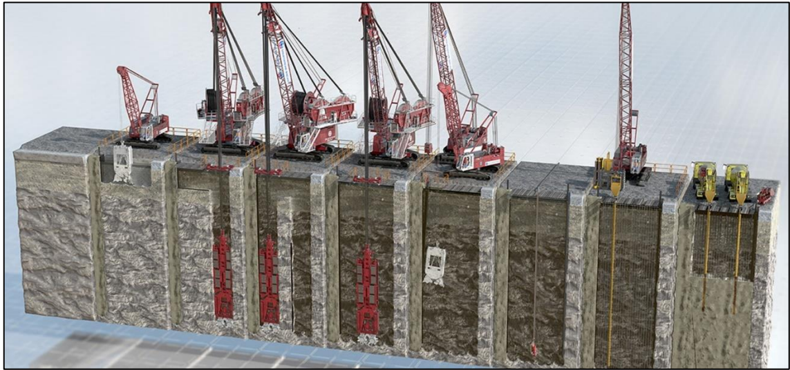
9. kép Résfal kivitelezésének munkafolyamatai. Forrás: [18]
