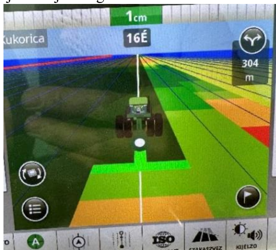
11. ábra: A vetés során alkalmazott zónatérkép szerinti vetés Greenstar kijelzőn (Saját fotó, myjohndeere App)
