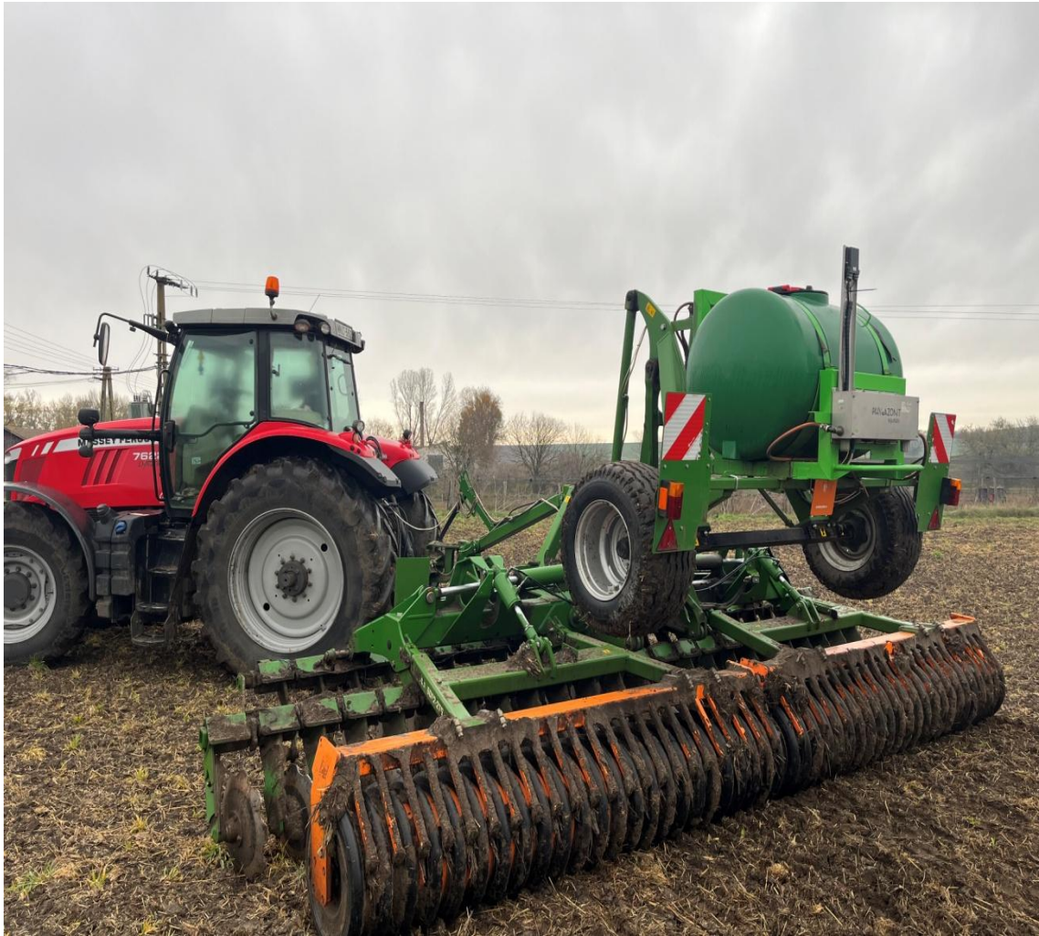
9. ábra Amazone Catros 6002- 2TS rövidtárcsa Phyller kijuttató szerkezettel (forrás: saját)
