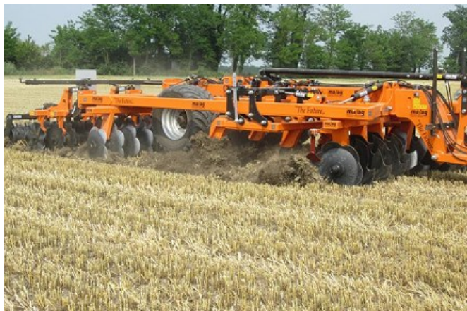
1.kép: MAAG FUTURE vontatott 3,2-6,2 m szupernehéztárcsa mélylazító kombináció (web3)
