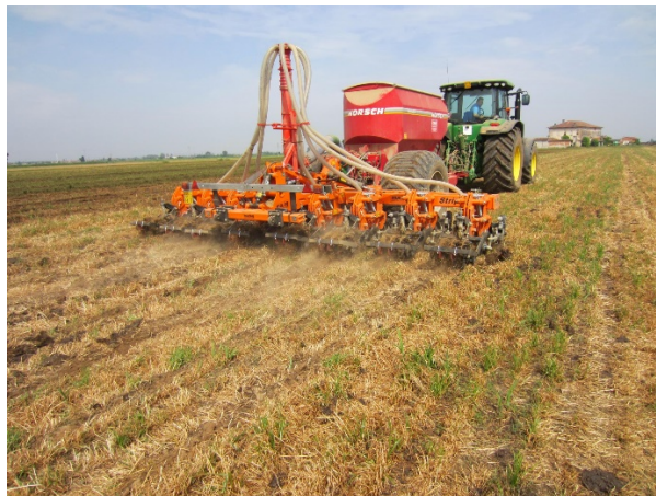
3.kép: MAAG COMBI STRIP Strip Till sávművelő eszköz (WEB5)
