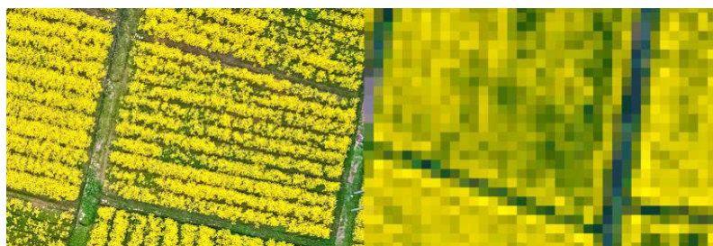
3.7. ábra [ https://wingtra.com/how-ground-sample-distance-gsd-relates-to-accuracy-and-drone-roi/ ] – GSD érték különbségének látható eredménye
