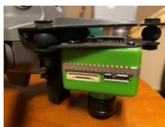
4.8. ábra – Egyállású mezőgazdasági kamerák rögzítése
