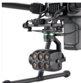
4.11. ábra [ https://sentera.shop/products/6x-system ] – Gimballal stabilizált, cserélhető kamerarendszer
