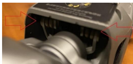
4.10. ábra – Gumipárnák a gimbal egységben
