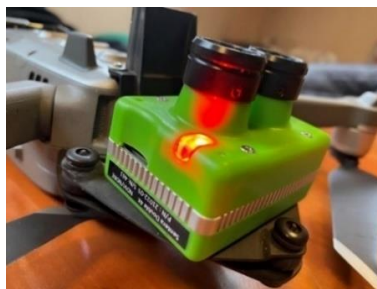
6.4. ábra - Sentera Double 4K True NDVI®+NDRE® Red-Edge mezőgazdasági kamera
