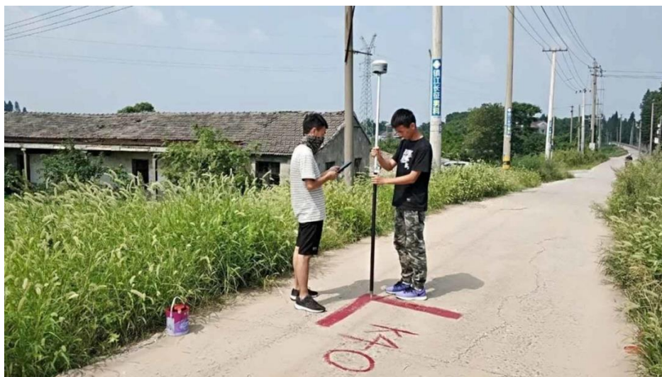
8-7. ábra GCP pont rögzítés roverrel [15]
