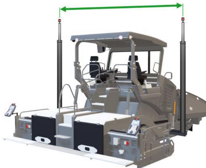
5. ábra Aszfaltbedolgozó gép hátsó nézetből. Az ábrán látható a két árbóc és a pad szélénél a két digitális vezérlőpanel melyeket a kalibráció során szükséges használnunk.
