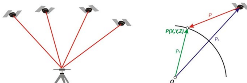
9.2 ábra: Abszolút helymeghatározás elve. forrás: (Ádám, Rózsa, & Takács, 2021)
