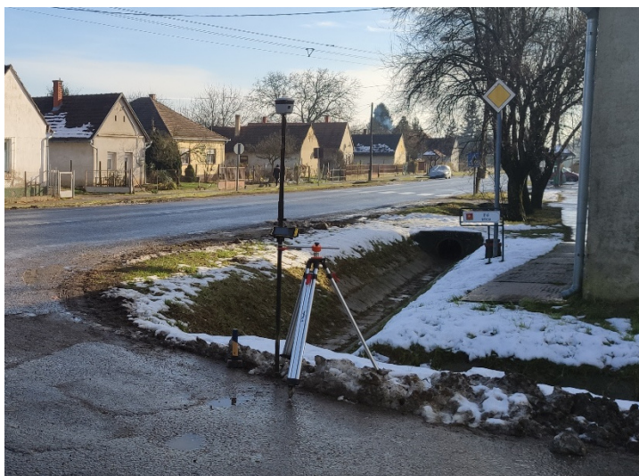
4-6. ábra Alappont létesítése műholdas helymeghatározással (Forrás: saját készítésű kép)
