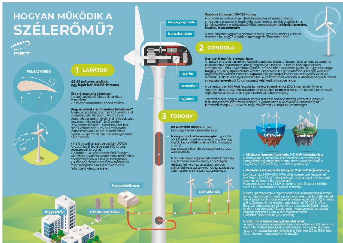
6. ábra: Szélerőmű komplex működési ábrája [http://www.nrgreport.com]
