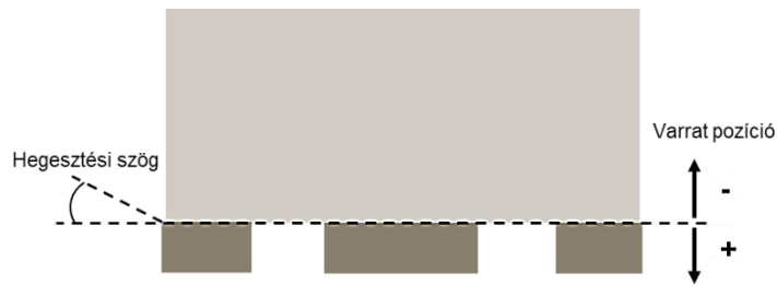
54. ábra: Hegesztési szög és varratpozíció a fúrókoronához viszonyítva [24]
