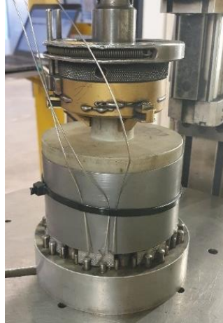
88. ábra: Hűlési idő meghatározási kísérlet [24]
