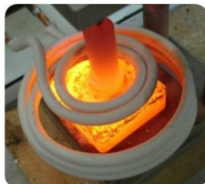
15. ábra Hevítés indukciós tekercessel [20]
