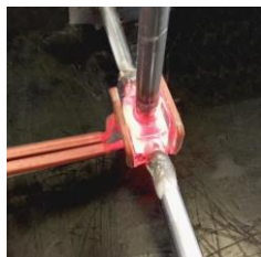
51. ábra: Nagyfrekvenciás, indukciós hegesztés [36]
