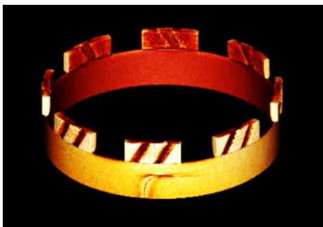
25. ábra: Fúrókorona CT felvétele [24]
