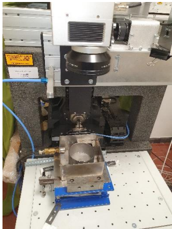
75. ábra: Femtoszekundumos lézeres kezelés 1) kísérleti összeállítás 2) pillanatkép kezelés közben [24]
