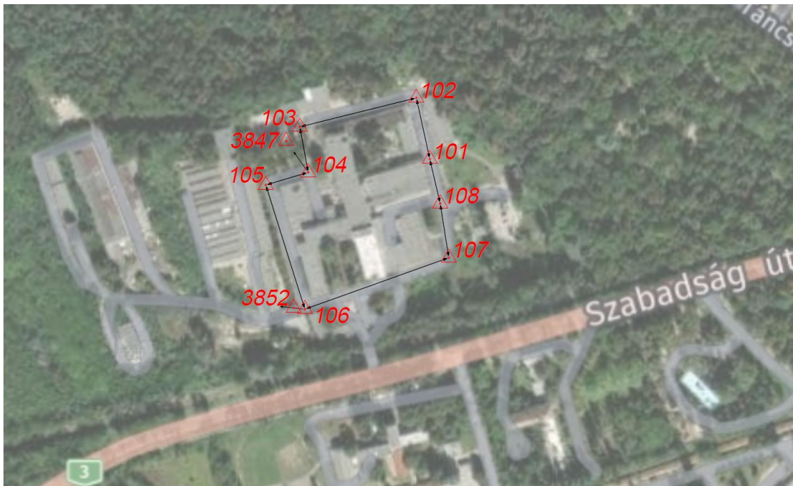
11. ábra: A Ganz Árammérőgyár területén állandósított 8 db új alappont (101-108) és a hálózat részét képező két régi felmérési kő (3847, 3852). (forrás: saját kép)
