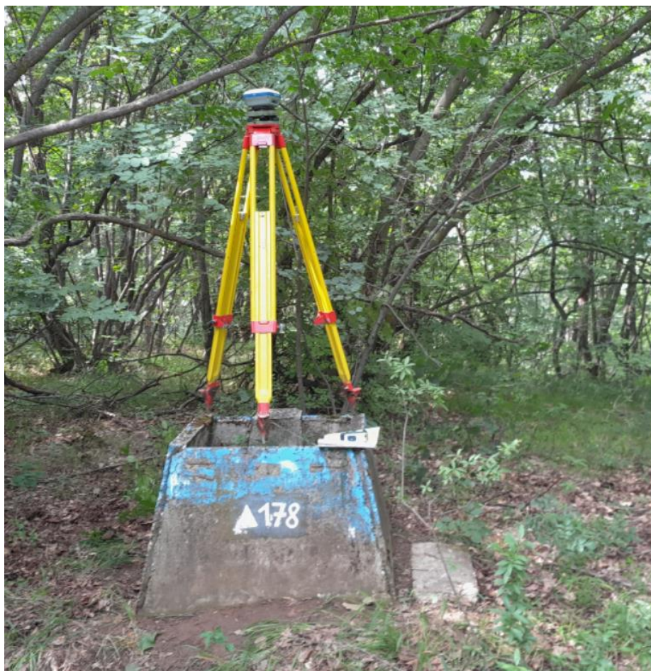
3. ábra: Egy nehezen kivitelezett pontraállítás és GPS mérés az Öreg-hegyen. A transzformációba bevont pontok felkeresése, mérése is izgalmas feladatnak bizonyult. (forrás: saját fénykép)
