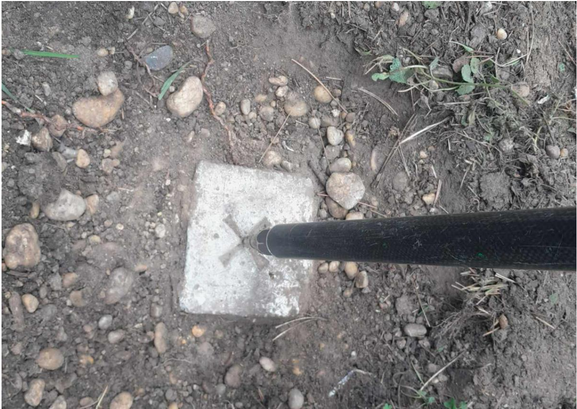
4. ábra: A 3847 számú, eredeti felmérési alappont. Ilyen kis méretű, keresztvesséssel ellátott köveket használtak az eredeti felmérés során. A pont átszámított koordinátáit GPS-sel tűztem ki, és néhány centiméternyi föld eltávolítása után elő is került. (forrás: saját fénykép)
