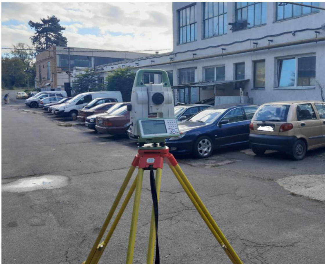
5. ábra: Irány- és távméréses alapponthálózati munka a gyártelepen. A transzformációval számított sztereografikus alappontok között sokszögvonalat vezettünk, és ellenőrző részletmérés is történt. (forrás: saját fénykép)
