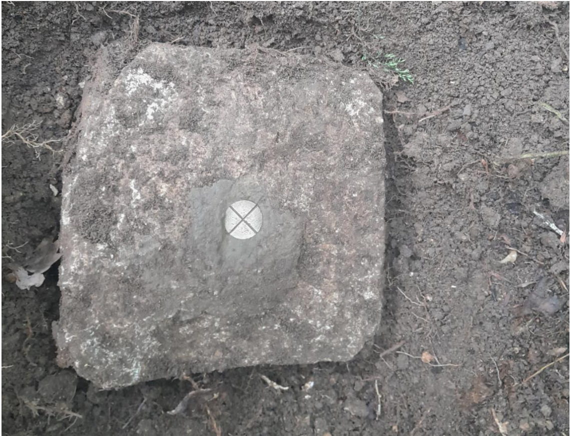
2. ábra: A Gyertyános alappont. 1926-ban állandósították, és a Budapesti Centrális Alapponthálózat egyik fő pontja is, alapvonal fejlesztő hálózati pont. A saját traszformáció számításomban szintén fontos szerepe volt. (forrás: saját fénykép)
