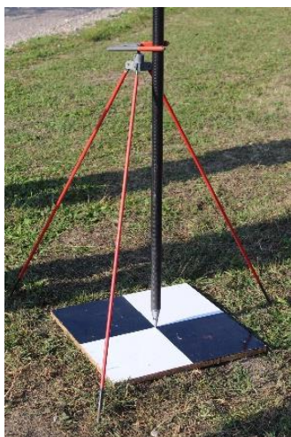
14. ábra: Fekete-fehér fa illesztőpont műanyag fedéssel
