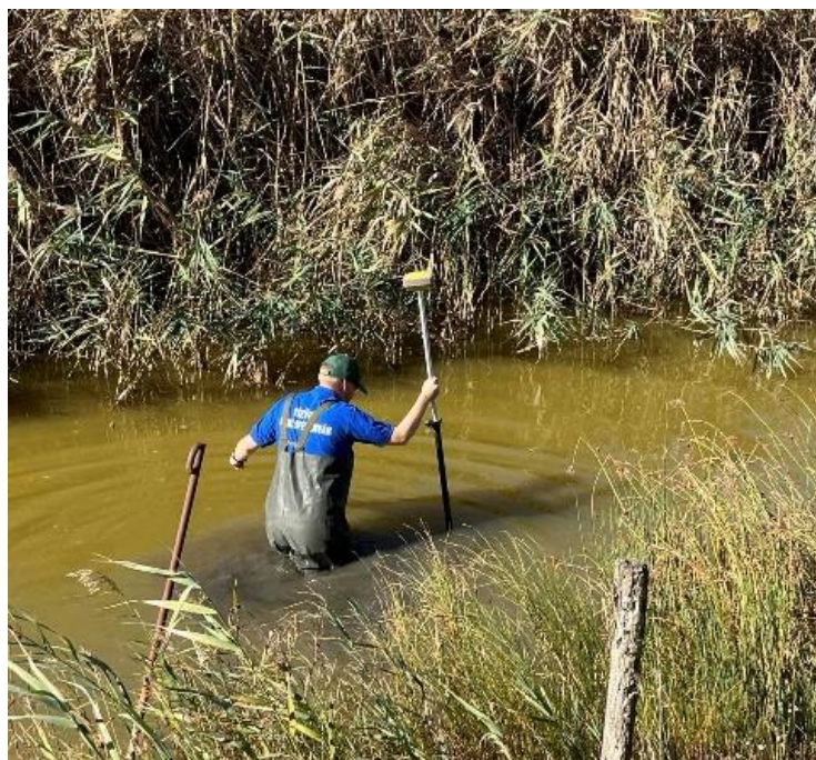
12. ábra: Szelvénymérés a csatornaszakaszon
