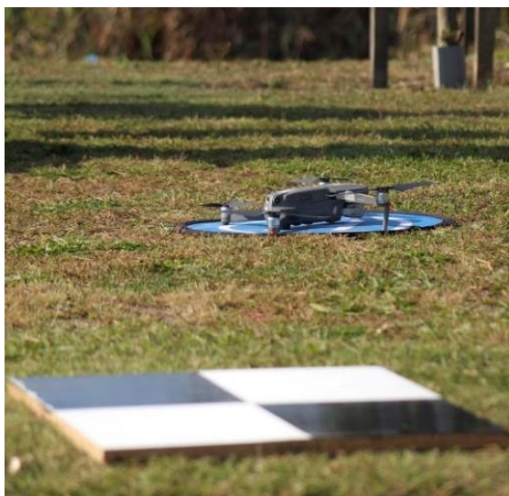
18. ábra: A drón és egy illesztőpont a mérés megkezdése előtt
