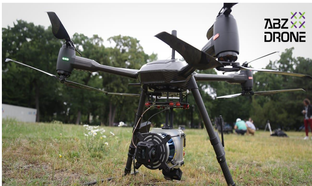
4.3.1 ábra: egy LIDAR-al szerelt drón látható - Forrás: [7]
