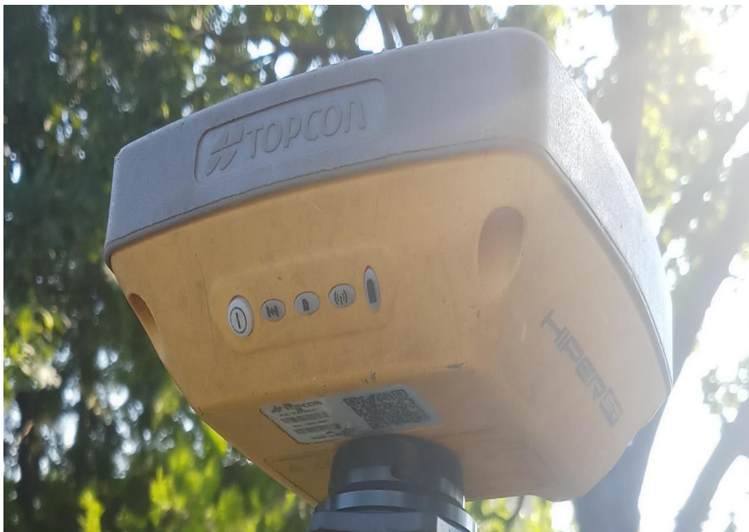
4.1.3 ábra A képen egy Topcon gyártmányú HiperSR GNSS vevő látható Forrás: [4]
