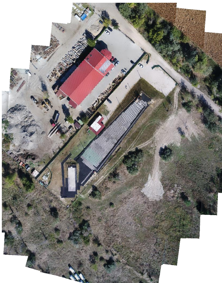
21. ábra Elkészült ortofotó a felmért területről [saját készítés-3D Survey szoftver]
