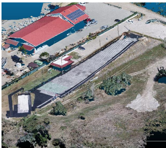
24. ábra Pontfelhő körül vágás és szegmentálás előtt [saját készítés-Cloud Compare szoftver]
