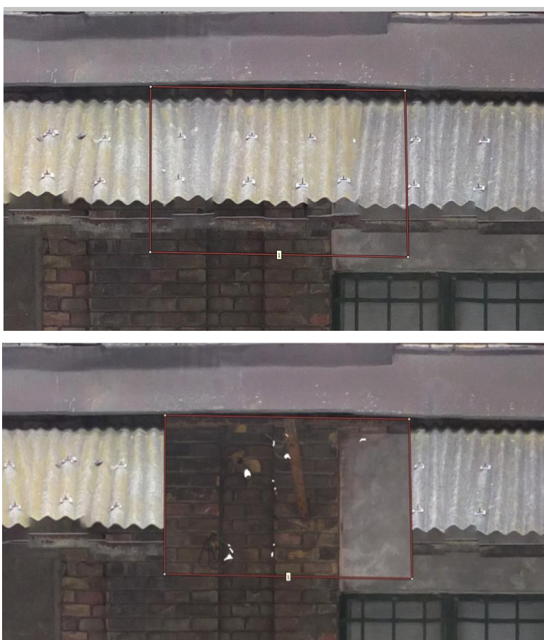
6.5. ábra: Az északi homlokzatról készült ortofotó részletének korrigálása
