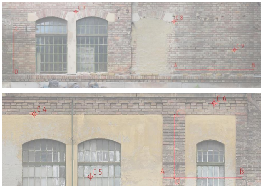
7.1. ábra: Ellenőrző hossz és pontmérések helyei a homlokzatokról készült ortofotók részletén
