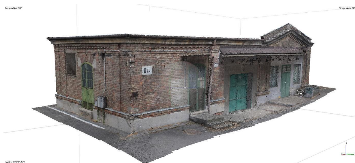
6.2. ábra: A tisztítás utáni sűrű pontfelhő
