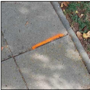
19. ábra A műszerállás helyét jelző festés
