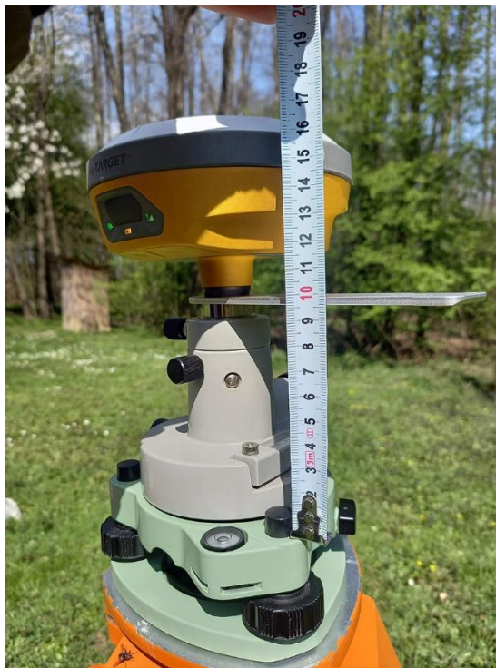
10. ábra A GNSS vevő műszermagassága és a templom előtti álláspont [saját képek]
