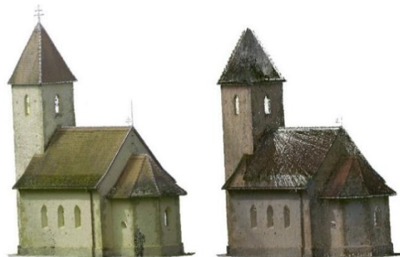
32. ábra (a) RTC360 pontfelhője (b) BLK2GO pontfelhője [saját kép]
