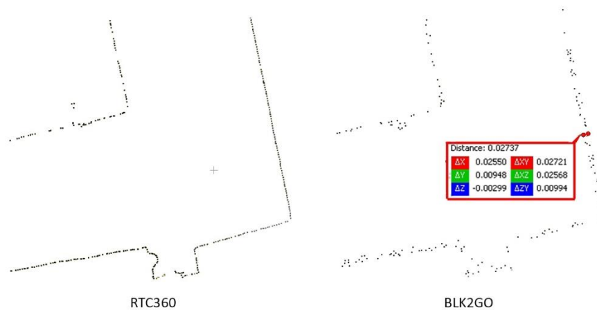
36. ábra Pontfelhőzajok közötti különbség [saját kép]
