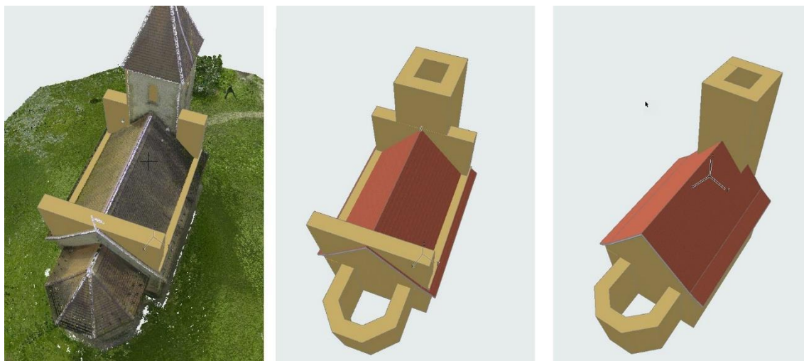
44. ábra Falak és tetők modellezésének folyamata Archicadben [saját kép]
