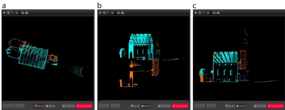
26. ábra Visual alignment (a) felülnézete elforgatás előtt, (b) oldalnézete elmozgatás előtt és (c) magasságilag igazított pontfelhők oldal nézetben [saját kép]
