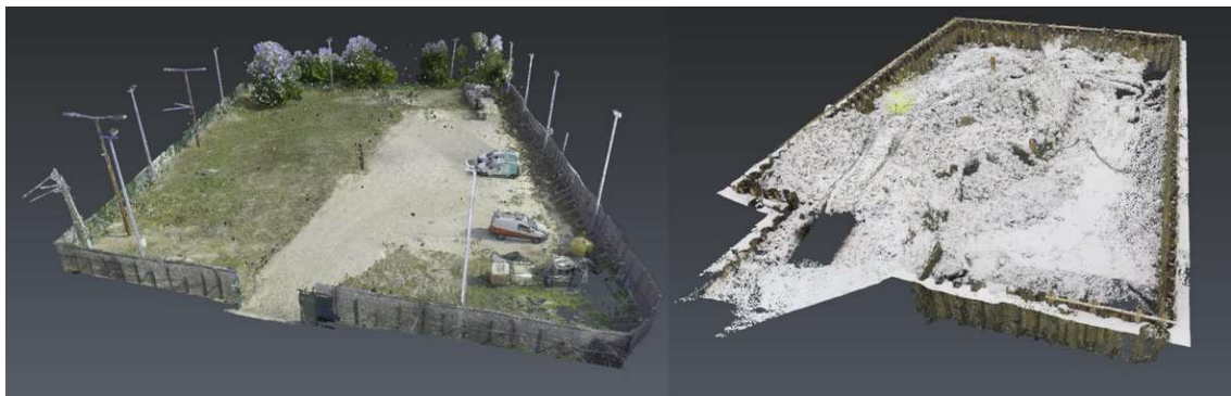
11. ábra – A munkálatok megkezdése előtti terepviszonyok és az eddig kiemelt földtömeg pontfelhői
