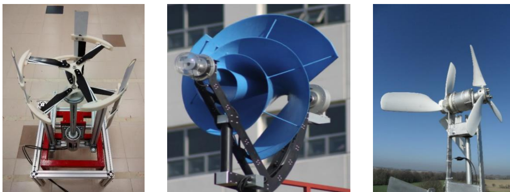
2. ábra. Keresztengelyű szélturbina [7], Archimédeszi csavarturbina [8], több rotoros szélturbina [9]
