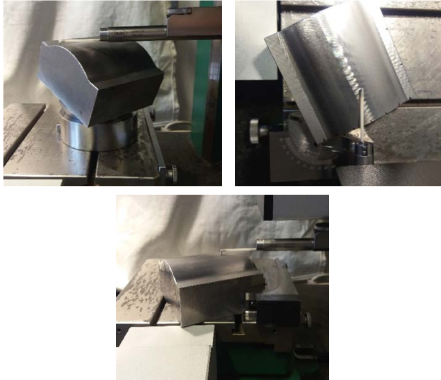
35. ábra: Felületi érdesség mérése
