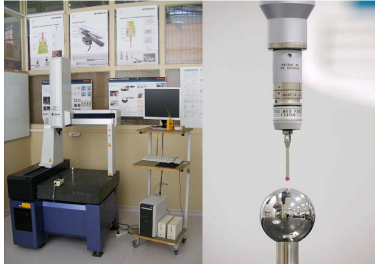
36. ábra: Mitutoyo Crysta Plus 544 koordináta mérőgép és tapintófej
