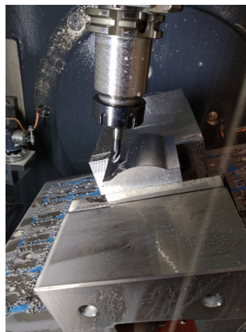
33. ábra: Simító megmunkálás az öttengelyes marógépen
