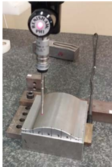
37. ábra: Koordináta pontok mérése a méret és geometriai meghatározásához
