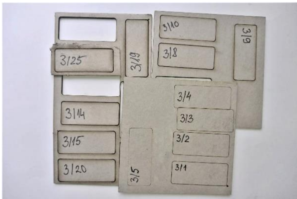
3.7. ábra: A kötészeti szürkelemezről vágott nem megfelelő mintadarabok [saját ábra]
