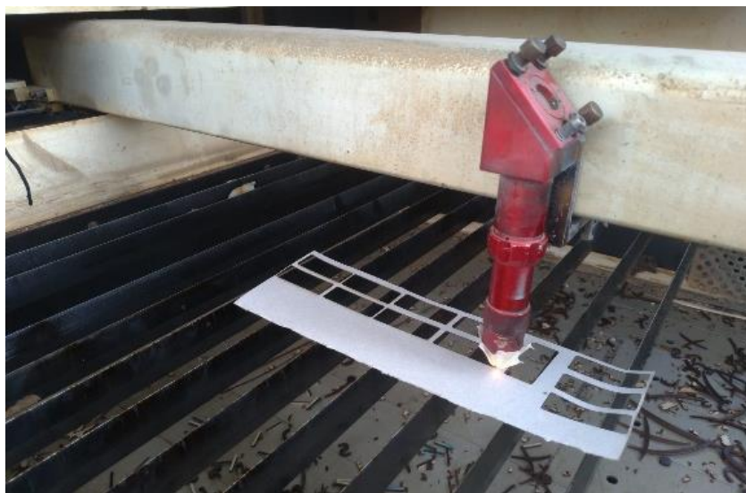
1.17. ábra: Duplex karton lézerstancolása [saját ábra]
