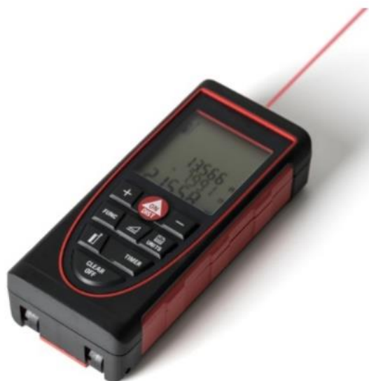
1.3. ábra: Az építőiparban használt lézeres távolságmérő és szintező [6]
