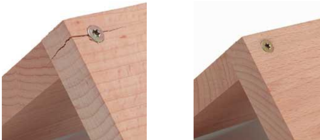
3.29 Előfúrás a hasadás elkerülése érdekében
