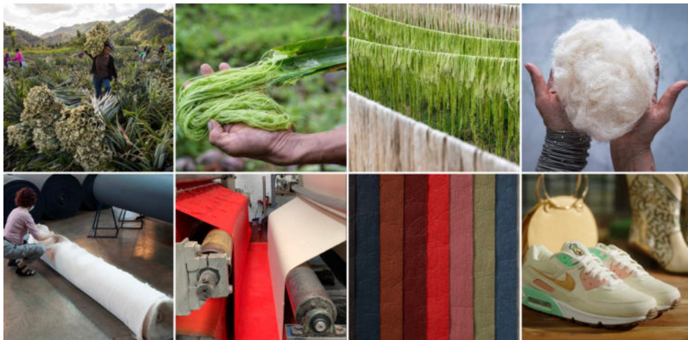
14. ábra Ananász bőr előállításának folyamata
