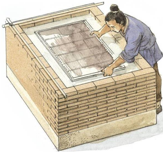
2.6. ábra: Papírmerítés merítőszítával, merítőkádból [1] [11]
