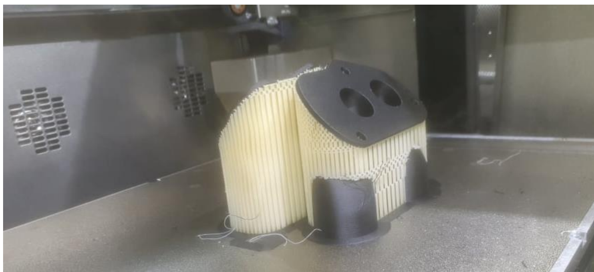
2.24. ábra, ASA-CF műszaki polimerből funkcionális prototípus (saját kép)
