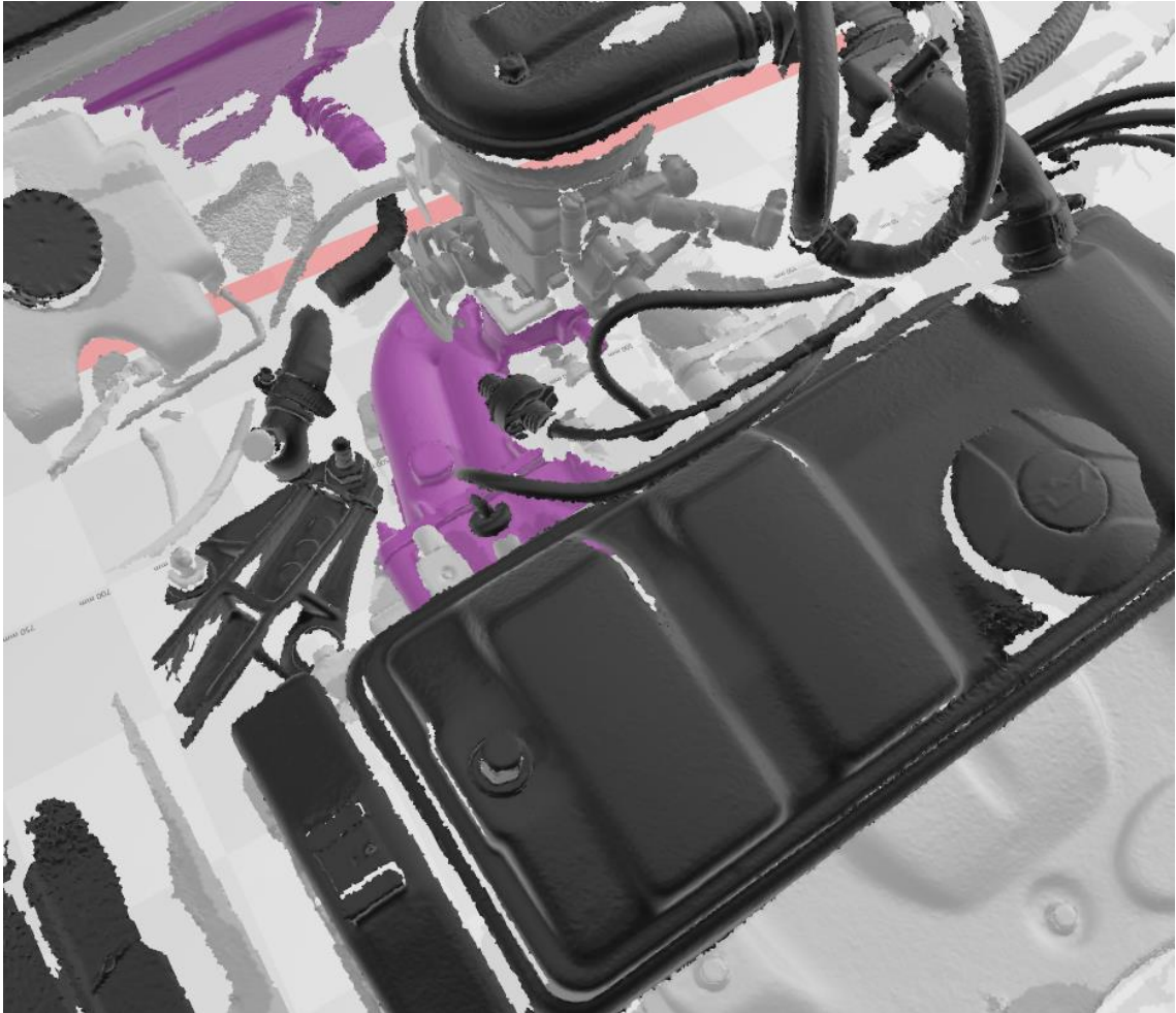
3.5. ábra, Felesleges felületektől megtisztított, színezett motortér-modellháló (saját kép)
