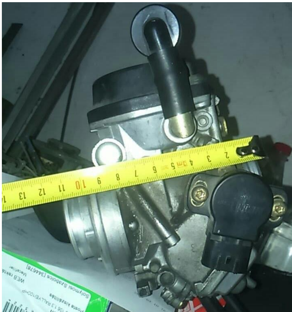
3.2. ábra, Karburátorsor ki, - és bemenő csonek közötti átfogó méret (saját fotó)
