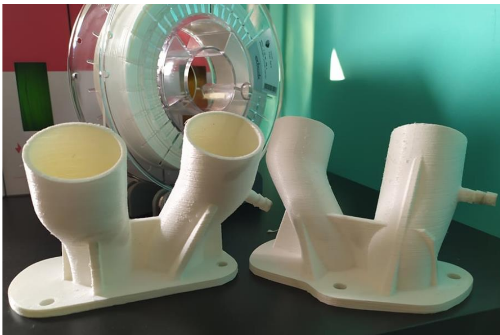
2.25. ábra, Frissen nyomtatott TPU csomák prototípusok (saját kép)
