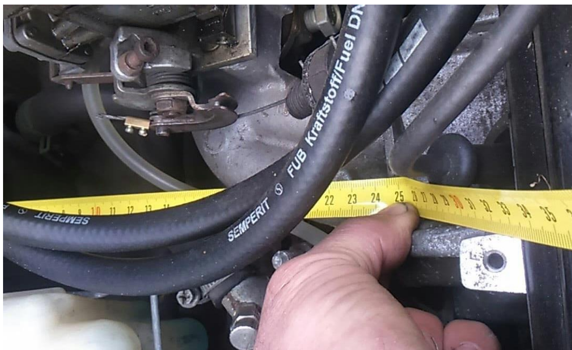
3.1. ábra, Szívócsonk felfekvő felületének mért távolsága a tűzfaltól (saját fotó)
