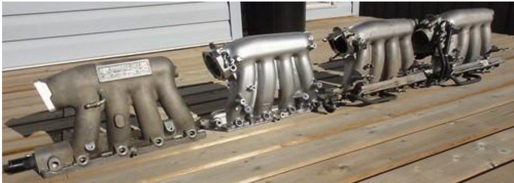
1.4. ábra, Honda K20 motorokra fejlesztett szívórendszerek összehasonlítása [4]
