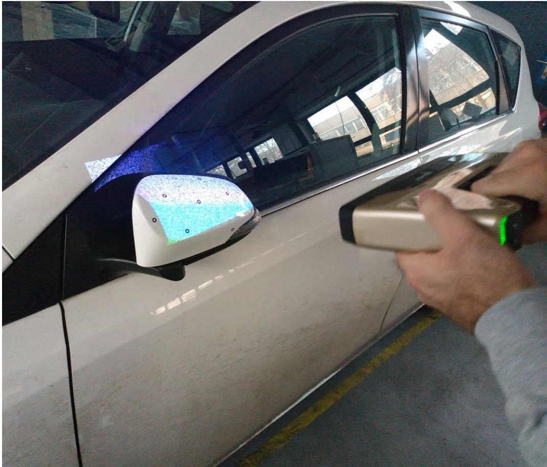
2.14. ábra, visszapillantó 3D szkennelése, járműmérnök BSc szakdolgozatomhoz (saját fotó)
