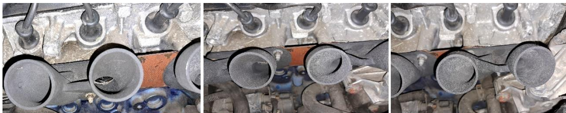
4.12. ábra, 3D nyomtatott szívócsonkok próbaszerelése (saját szerk. fotó)
