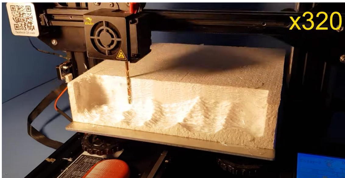
3.18. ábra: 3D nyomtató Hőforgácsoló CNC-vé alakítva
