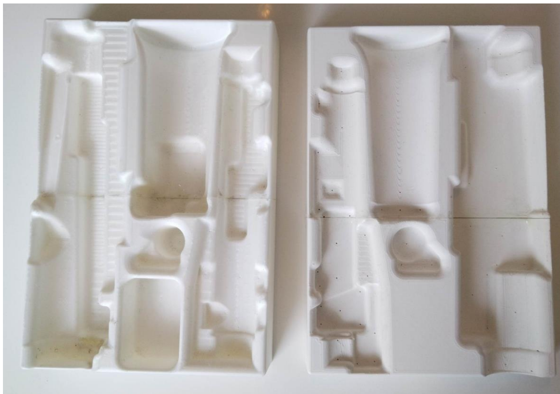
4.5. ábra: Pozitív vákuumformázó szerszám
