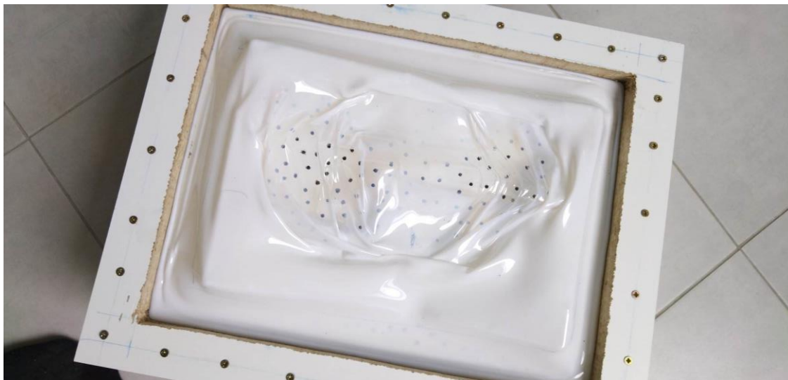
4.6. ábra: A meghíúsult vákuumhúzás eredménye
