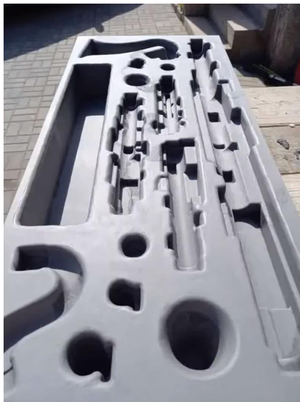
4.3. ábra: Elkészült PU hab forma tripla tokhoz
