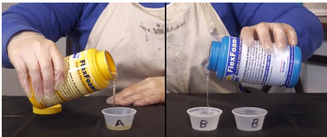
3.19. ábra: FLEX Foam-it! PU hab komponensei
