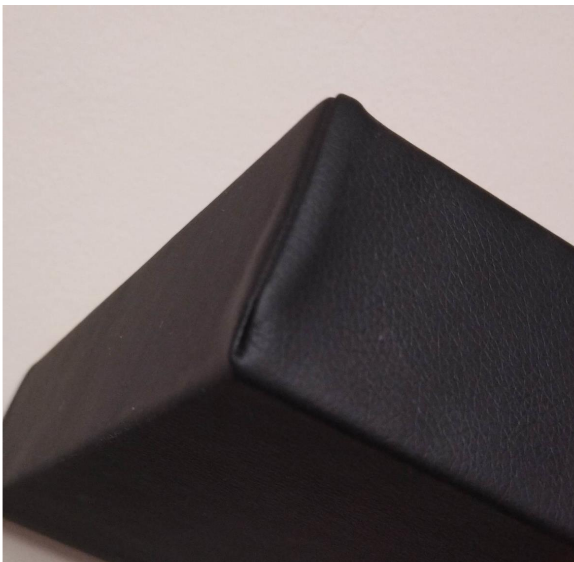
4.14. ábra: Túlzott anyagvastagság a varrott saroknál
