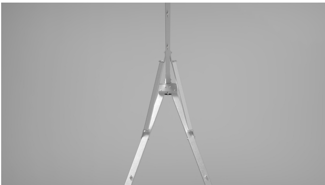
4.13. ábra: Render modell, sarokcsomópont és saroktámaszok belső oldalról nézve
