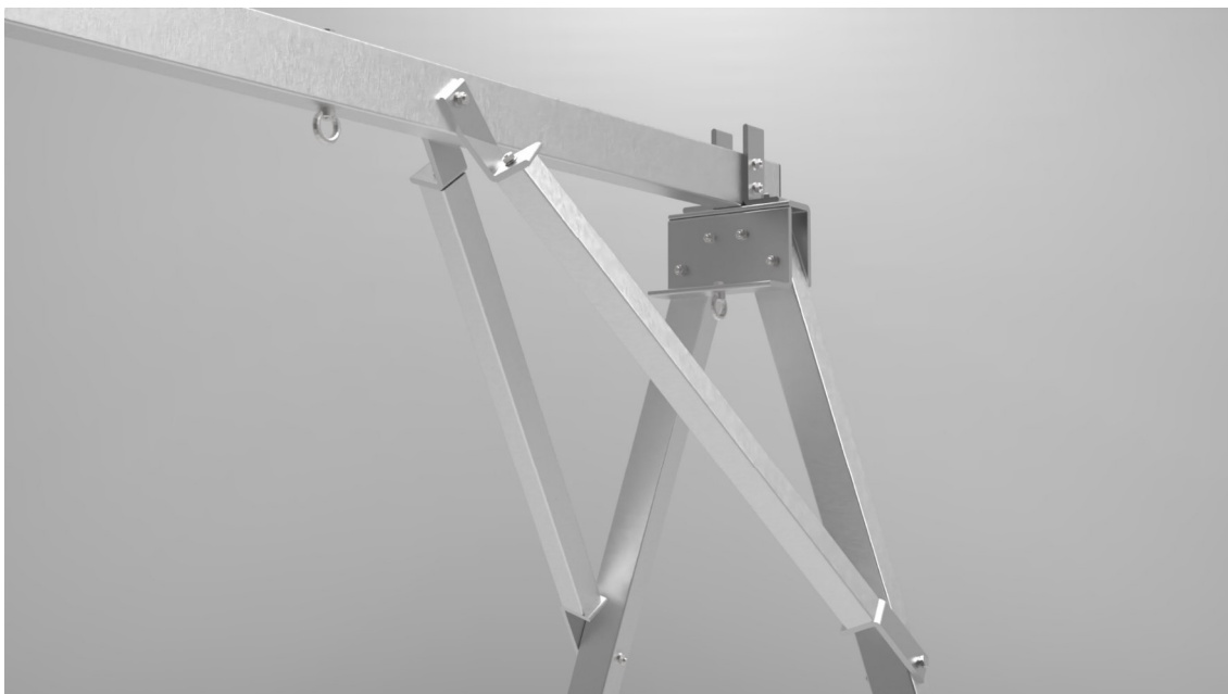
4.12. ábra: Render modell, sarokcsomópont és saroktámaszok axonometrikus nézetben
