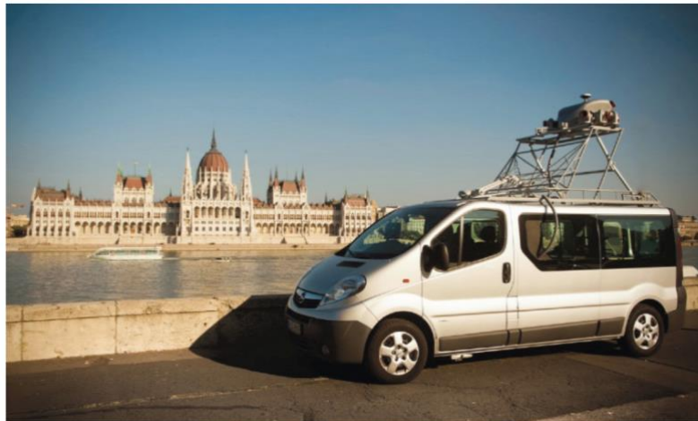
21. ábra BKK autóra szerelt kamera [9]
