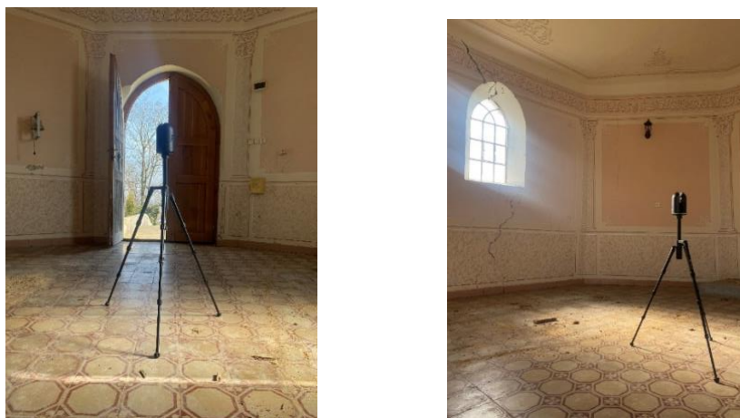
28. ábra, Kápolna lézerszenneres felmérése
