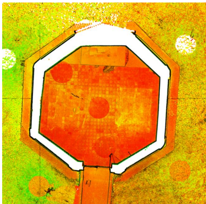
51. ábra, Kápolna pontfelhő, 2 m-es magassági szelet
