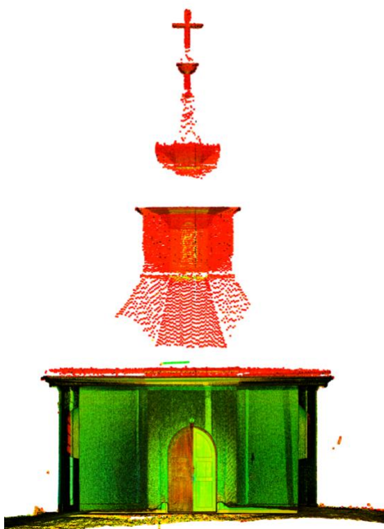
52. ábra, Kápolna homlokzati pontfelhő
