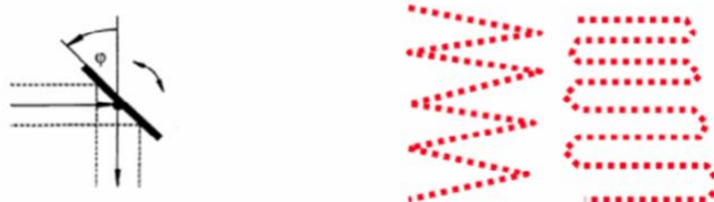
13. ábra Oscilláló tükrös szkennert működési elve és a mért pontok elhelyezési [8]
