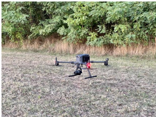
7. ábra, Terpi felmérés, drón felengedése, DJI Matrice 300 RTK Zenmuse
