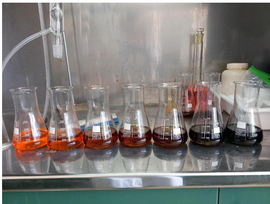
5. ábra: A kalibráló oldatok koncentrációja balról jobbra növekvő sorrendben: 0,0 - 0,5 - 1,0 - 1,5 - 2,0 - 3,0 - 4,0 % szervesanyag-tartalomnak megfelelően.
