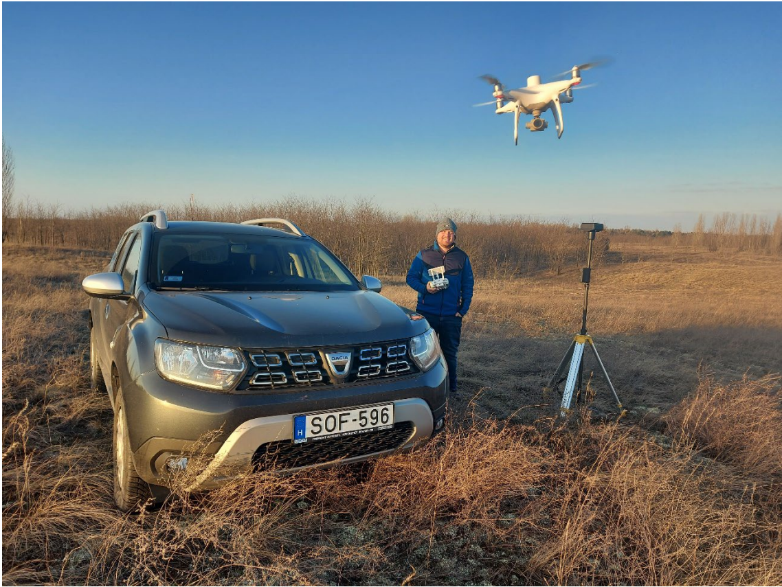
7. ábra: Terepi mérés végrehajtása DJI Phantom 4 RTK drónnal, és D-RTK 2 GNSS bázissal [saját kép]
