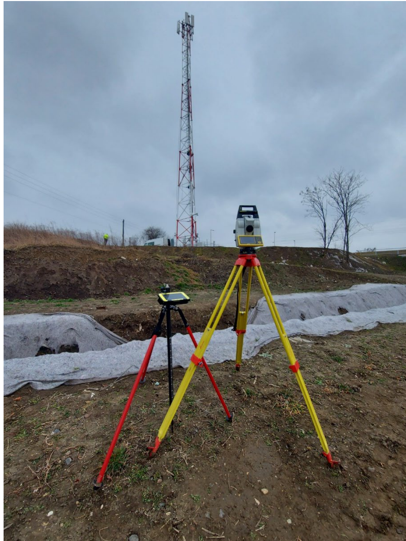
17. ábra: Leica iCON iCR80 robot mérőállomás terepi mérés során [saját kép]
