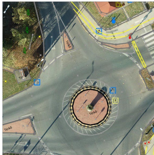
29. ábra: Tervezési alaptérkép az útmutató szerinti főliakiosztással és ortofotóval - Autodesk Civil 3D [2. példa] [saját ábra]
