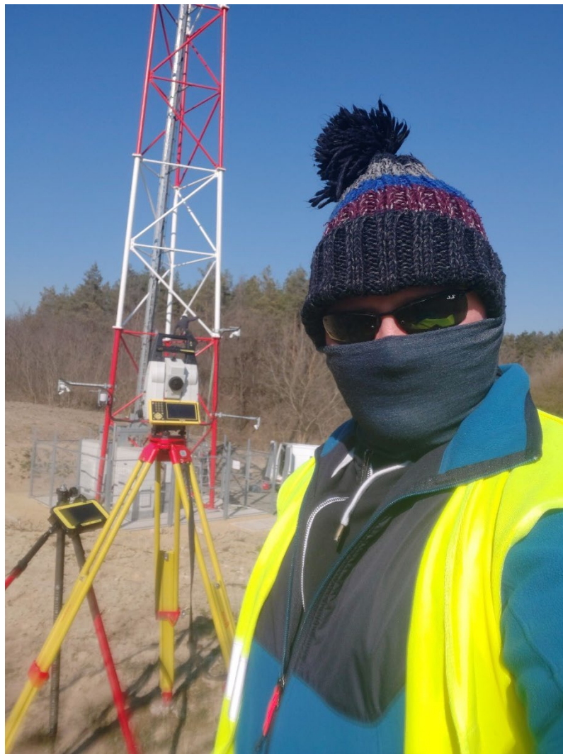
18. ábra: Téli munkavégzés a Leica iCON iCR80 mérőállomással [saját kép]
