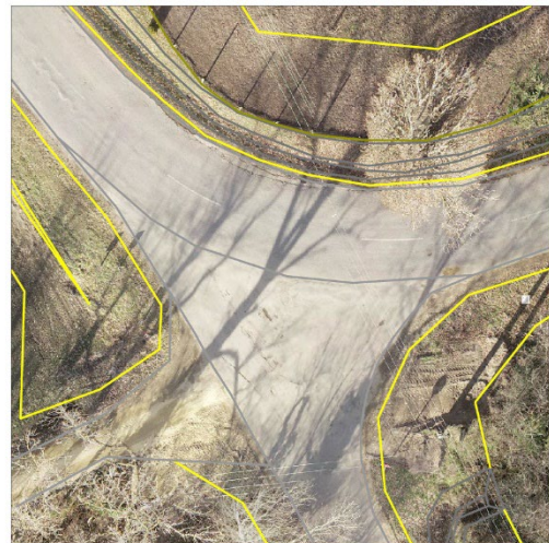
41. ábra: Tervezési alaptérkép az útmutató szerinti földiakiosztással és ortofotóval - Autodesk Civil 3D [5. példa] [saját ábra]
