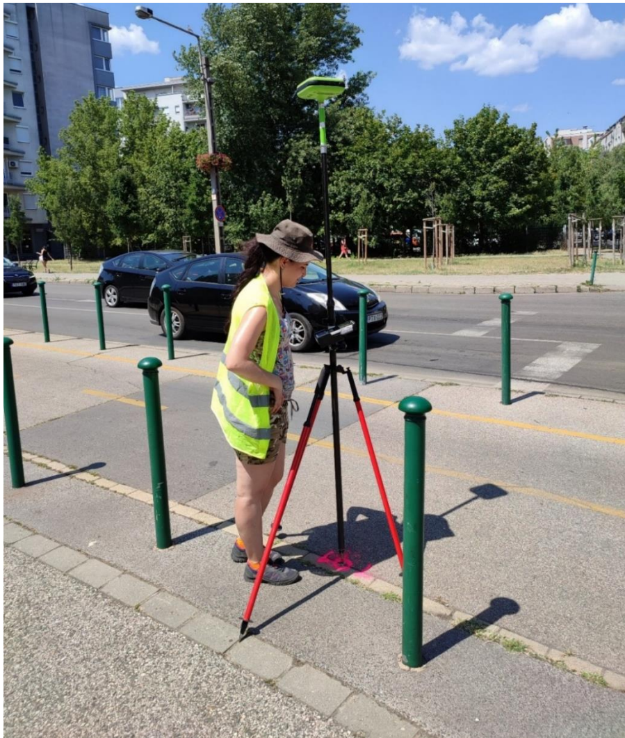
5.2. ábra: Alappont meghatározás.
