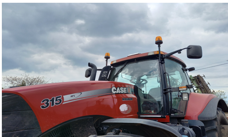
7. ábra Case IH Magnum 315, GPS antennával a tetején (saját kép)
