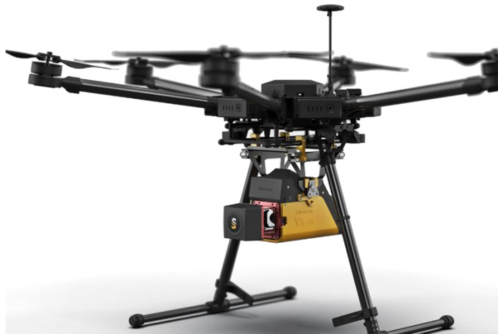
2.8. ábra: Drónra szerelt LiDAR szenzor
