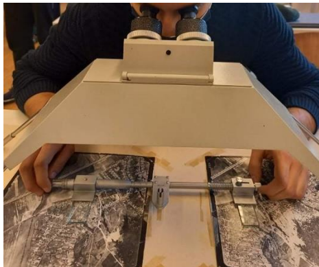
2.5. ábra: Manuális adatfeldolgozás sztereoszkóppal
