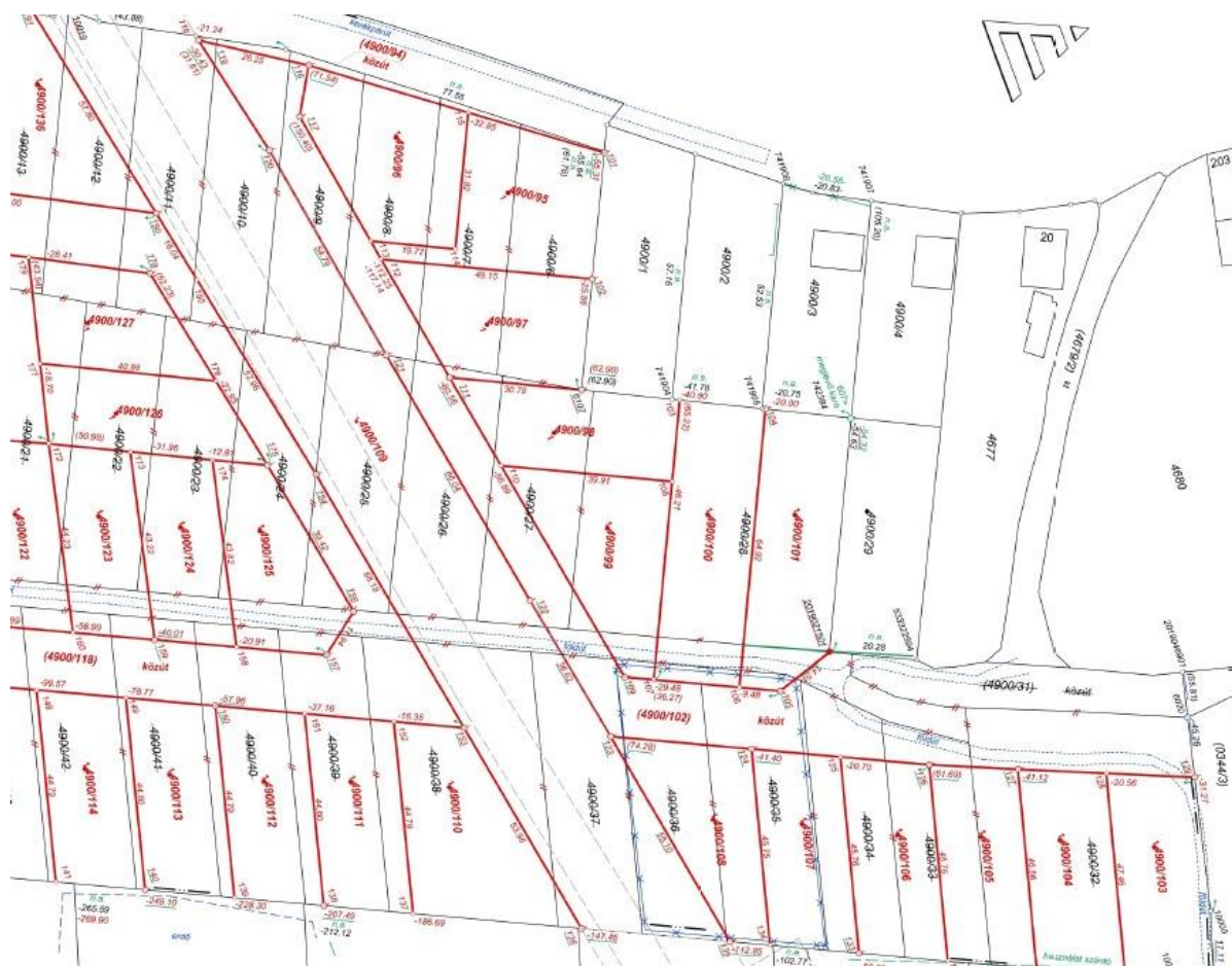
11. ábra Telekcsoport újraosztás mérési vázlatának részlete.
