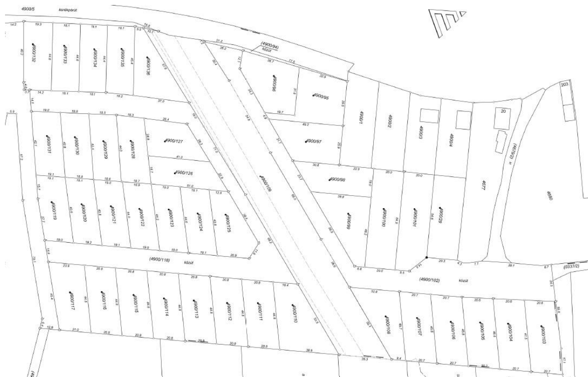
12. ábra Telekcsoport újraosztás telekalakítási helyszínrajzának részlete.
