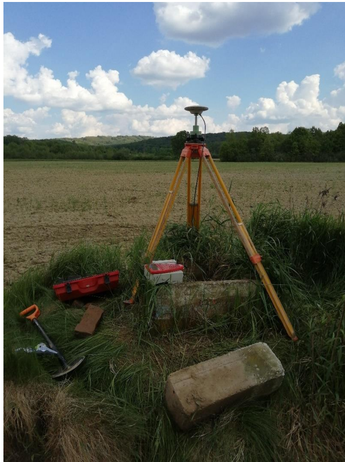
18. ábra GPS mérés 31-4114 OGPSH ponton (Saját kép)
