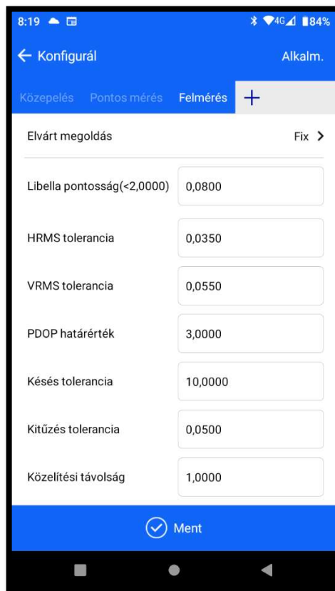
15. ábra: konfigurációs értékek a kontroller kezelőfelületén.
