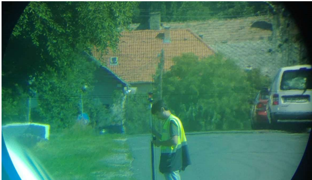
21. ábra: Műszer szálkeresztje és a prizma középpontja közötti eltérés az ATR funkció közben.
