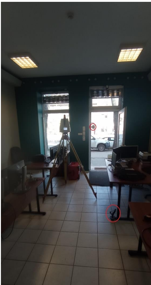
20. ábra: Az 1. irodában felállított műszer és a 1,2 illesztőpontok helye.
