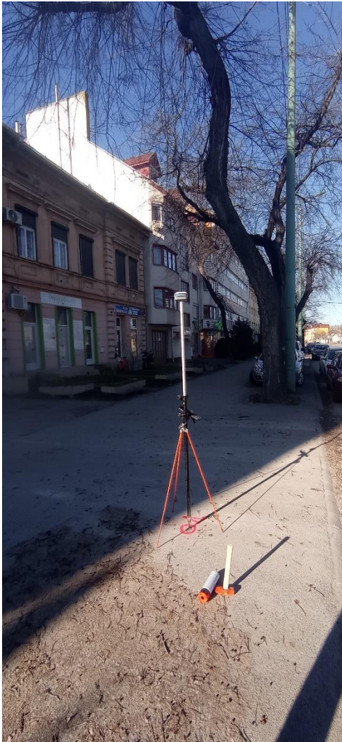
14. ábra: Alappont meghatározása CHC-GNSS vevővel és jelölése.
