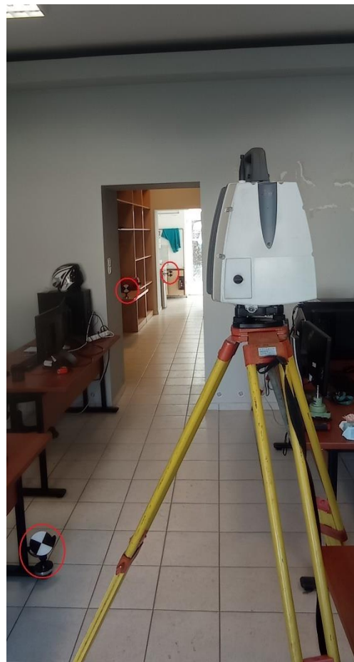
21. ábra: Az 1. irodában felállított műszer és a 2,3,4 illesztőpontok helye.
