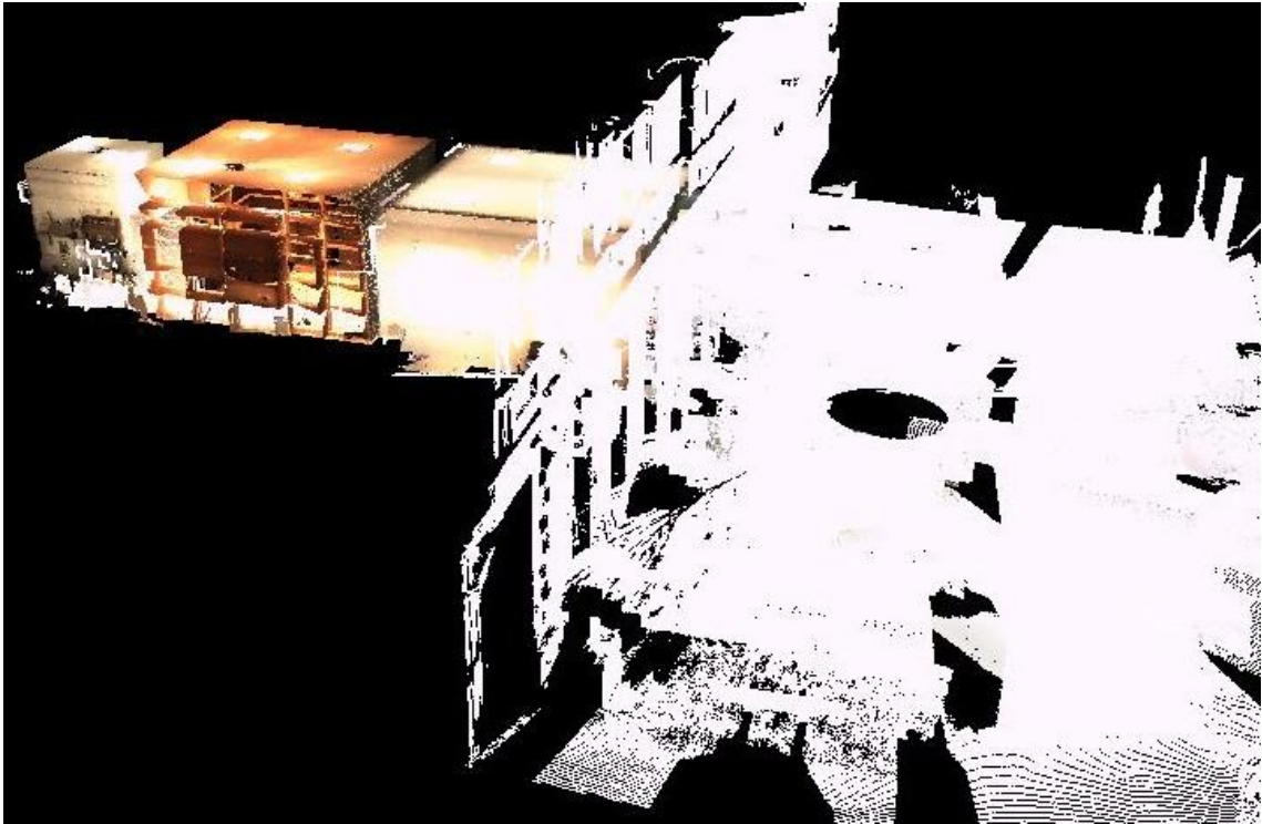
18. ábra: A lézerszkennerek képei közötti különbség bel-, illetve kültéren.
