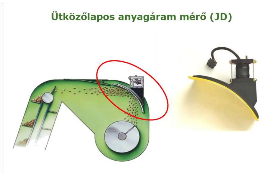
12. ábra: Ütközőlapos anyagáram mérő szenzor (Forrás: Internet, 12)
