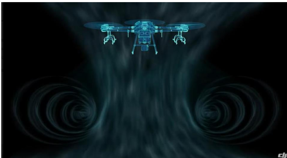
4. ábra DJI drón rotor keltette áramlat (Forrás: DJI,2022)
