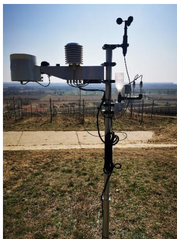
5. ábra: Meteorológiai állomás a teszterületen (Forrás: saját fotó)
