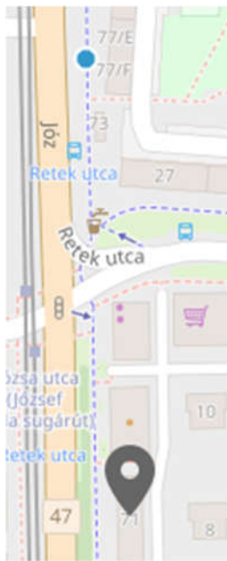
3-13. ábra: Az Ip címből adódó rossz helyzetmeghatározás, és a valós helyzet
