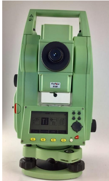
6.8. ábra: Leica TCR 405 mérőállomás [Forrás: https://www.precision-geosystems.com/product/leica-tcr-405-power-5-reflectorless-total-station/?v=f24485ae434a ]
