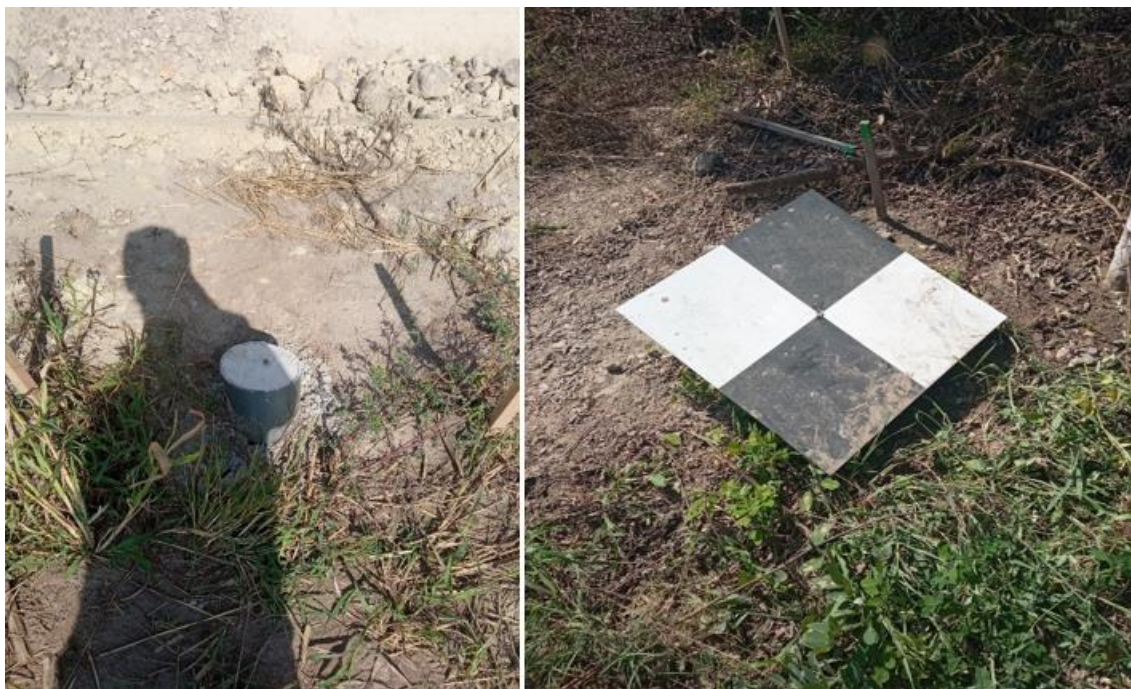
6.1., 6.2. ábra: Elhelyezett alappontok, a jobb oldalon fotogrammetriai mérésekhez alkalmazott pontjellel [Forrás: saját kép]
