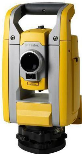
6.4. ábra: Trimble S3 2 DR mérőállomás [Forrás: https://trimbles3totalstations.weebly.com/ ]
